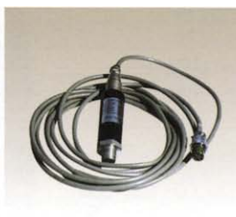
圧力センサ (VPRN-A2-1000型) 0~10kPa=1~5VDC出力 Pressure sensor
